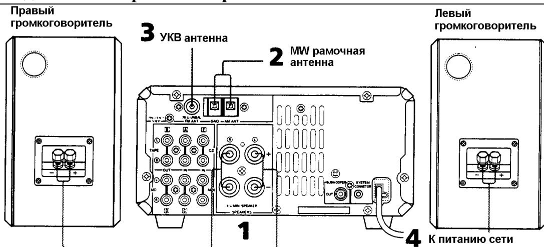
1. Подключите громкоговорители к разъему SPEAKER. Для этого отверните зажимы против часовой стрелки, вставьте оголенный конец кабеля в прорезь, поверните зажим по часовой стрелке так, чтобы кабель прочно держался. Соблюдайте полярность: красный кабель – плюс (+), черный – минус (-).
