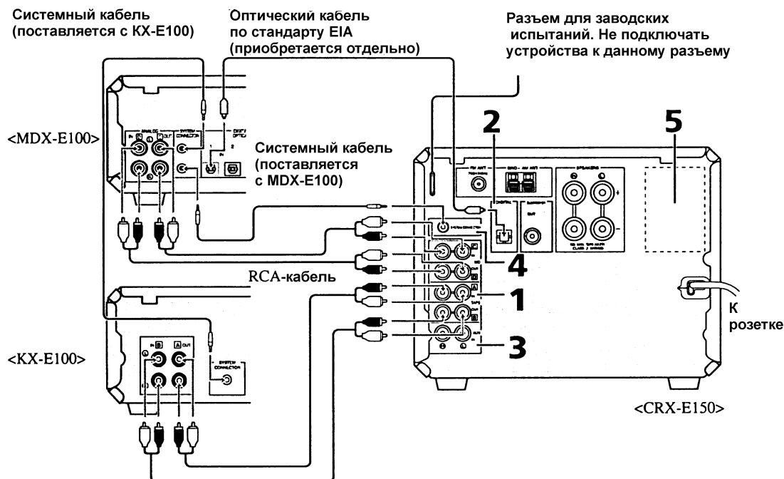
1. Соедините при помощи RCA кабеля гнезда A с A и B с B (для KX-E100), а также C с C и D с D (для MDX-E100).
